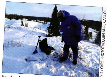
Un chercheur effectue des mesures de température de la neige près du village de Kuujuaupik. Le manteau neigeux influe sur la température du pergélisol.
